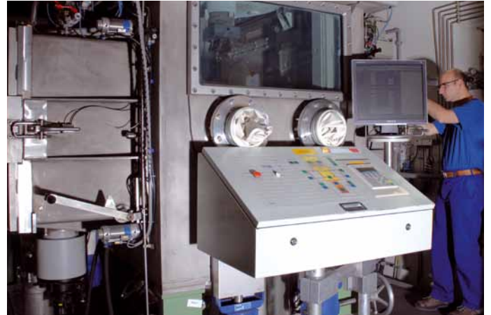
HTE Beschichtungskammer / HTE plating chamber
