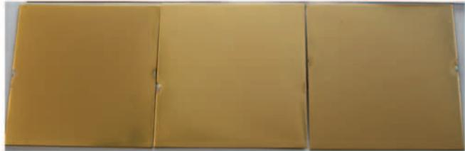
Hartgold-Schichten, die im Sealing 691 nachbehandelt wurden, zeigen nach 72 h NSS einen guten Oberflächenzustand, während die Referenzproben ohne Nachbehandlung Korrosion aufweisen.
