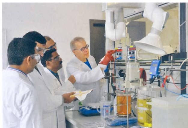
Schulung im komplett neu eingerichteten Technikum mit Modulbehältern in 200 Liter-Einheiten, verkleinerbar auf 100 Liter. Die neue Versuchsgalvanik arbeitet mit einer Gleichstromversorgung bis 150 Ampere, Filtration im Überlauf und einer regelbaren Anströmung der Kathode sowie mit einer umlaufenden Absaugung.
