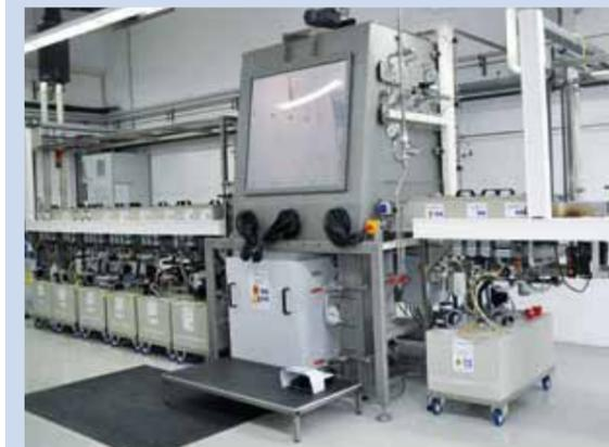
Die neue Bandbeschichtungsanlage von Umicore Electroplating.
