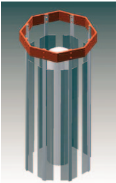
Abb. 2: Mit Hochtemperaturolektrolyse beschichtete Platin/Titan-Anoden sind dimensionsstabil. Sie bewahren meist über einen langen Zeitraum ihre Form
