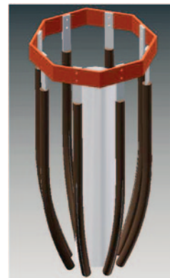
Abb. 1: Bleianoden verformen sich meist relativ schnell im Elektrolyten
