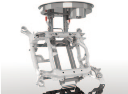
Motorträgerkonsole, beschichtet mit einem Zink-Lamellensystem
