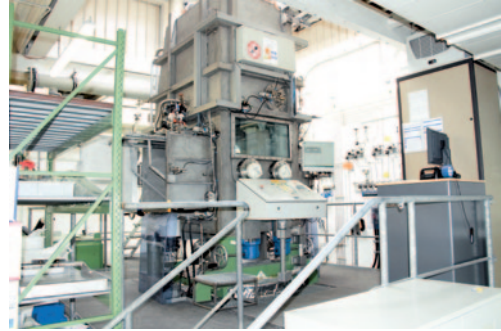
Abb. 6: Umicore beschichtet Anoden mit Hochtemperatur-elektrolyse. Bei diesem Verfahren wird in einer 550 Grad Celsius heißen Salzschnmelze Platin in einer Argonatmosphäre auf Basismaterialien wie Titan, Niob, Tantal, Molybdän, Wolfram, Edelstähle und Nickellegierungen abgeschieden
