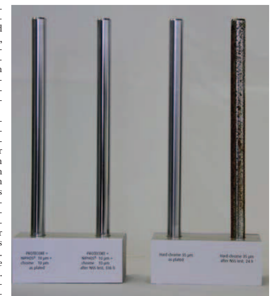
Während reine Chromschichten schon nach 16 h bei einer Schichtdicke von 20 µm oder nach 24 h bei einer 35 µm dicken Schicht massive Anzeichen von Korrosion zeigten, waren Materialproben insbesondere zweilagiger Nickel-Phosphor-/Chrom-Systeme auch nach 336 h noch nahezu unverändert. Bild: Umicore
