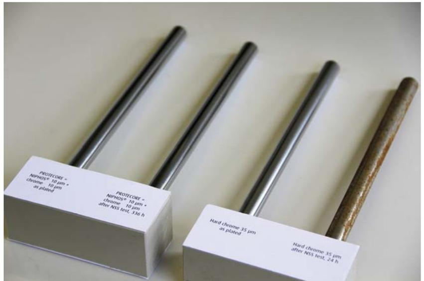
Nach NSS-Test: Der einlagig mit Chrom beschichtete Stab (rechts) zeigt nach 24 h Rotrost. Der Stab mit kombinierter Nickel-Phosphor- und Chromschicht (zweiter von links) übersteht 336 h ohne Probleme. (Bild: Umicore Galvanotechnik)
