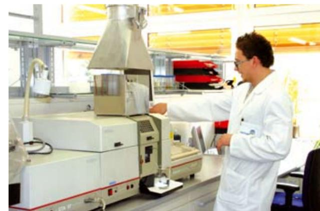
Messplatz AAS - Atomabsorptionsspektrometrie
